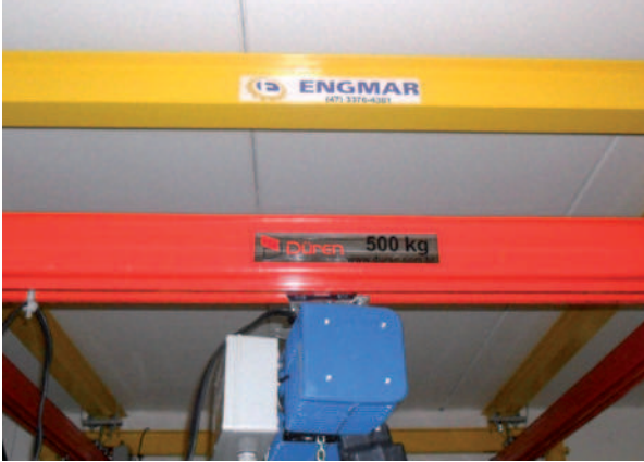
Estrutura com sistema modular para capacidades até 2t com arraste manual
